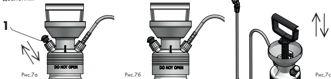
Рис.7а Предохранительный клапан открыт
