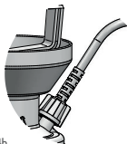
Fig.3 Il faut raccorder le tuyau d'aspiration, faisant partie de l'ensemble (fig. 3/ pos. 1), avec le joint du flexible (fig. 3/ pos. 2).
